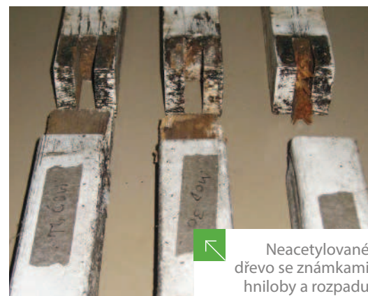
Neacetylované dřevo s vážnými známkami hniloby a rozpadu
