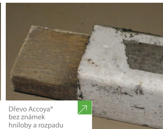
Neacetylované dřevo s vážnými známkami hniloby a rozpadu
