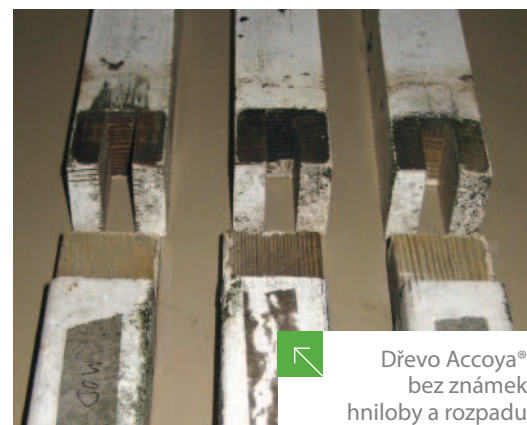
Neacetylované dřevo se známkami hniloby a rozpadu
