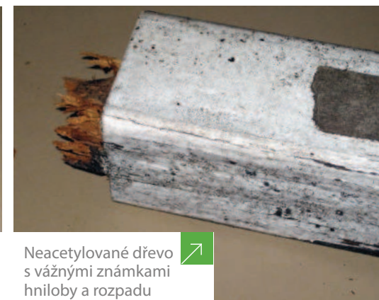
Neacetylované dřevo se známkami vážného napadení
